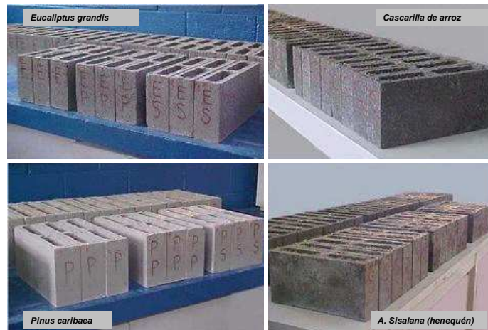
Figura 2 - Bloques huecos de Eucalyptus , Pinus , Cascarilla de arroz y Agave sisalana .
