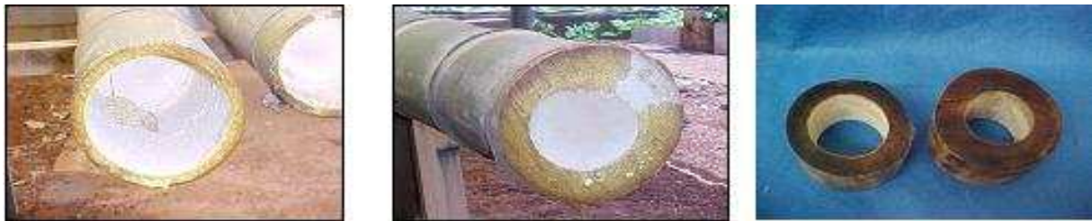
Figura 2: (a) Colmo de parede fina; (b) Colmo de parede espessa; (c) Anéis após aplicação de cromoazurol (base e topo do tratamento, respectivamente).
