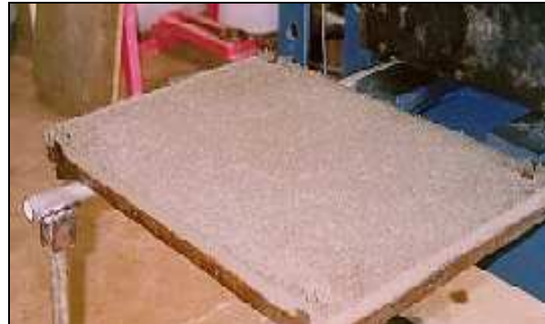
Figura 2- Chapa após a desmoldagem
