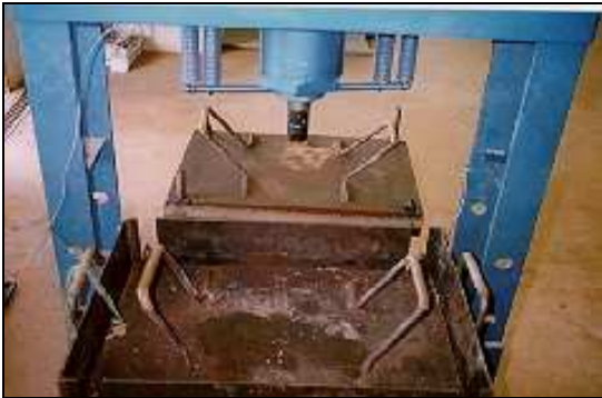
Figura 1- Prensagem da chapa
