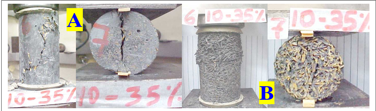
FIGURA 3: CORPOS-DE-PROVA DE PASTA (A) E DE COMPÓSITO (B), APÓS OS ENSAIOS DE COMPRESSÃO AXIAL E DE TRAÇÃO POR COMPRESSÃO DIAMERAL ( Brazilian Test ).
