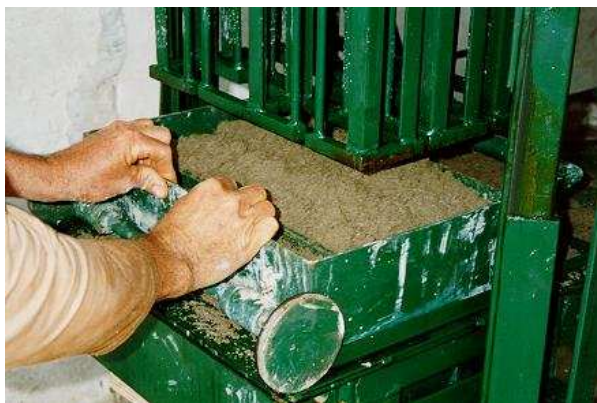
Figura 1. Moldagem dos blocos vazados
