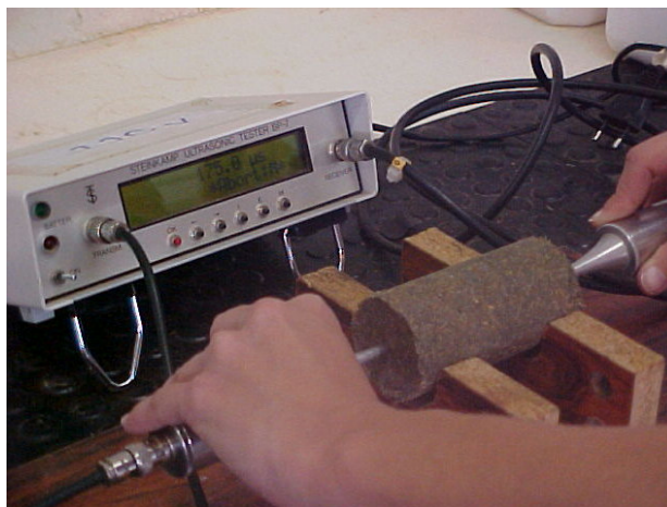
Figura 1. VPU através dos corpos-de-prova. Ultrasonic Tester, modelo BP7 da STEINKAMP.
