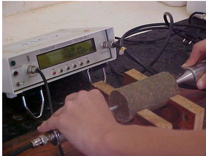
Figura 2. Ensaio: velocidade de propagação da onda ultra-sônica nos corpos-de-prova - Ultrasonic Tester, modelo BP7 da STEINKAMP
