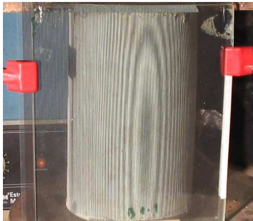
Figura 4. Curvas en nivel generadas por franjas de Moiré sobre cuerpo-de-prueba de bambú ( Guadua angustifolia ), sin nudo.
