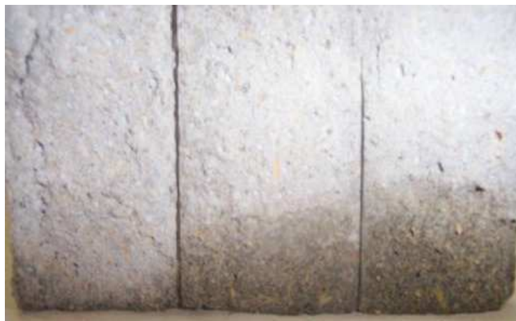
Figura 6 Ascensão da água, da esquerda para direita os tratamentos, Impermeabilizante, Testemunho e Plastificante.
