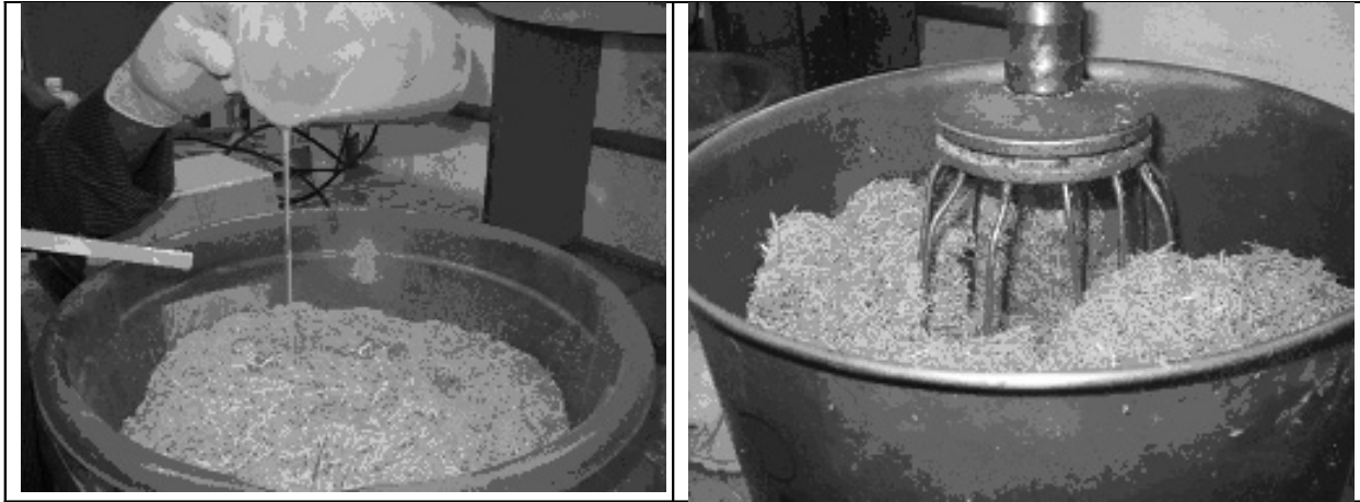
Figura 7 - Adición de la resina a las partículas. Figura 8 - Homogeneización de la mezcla.
