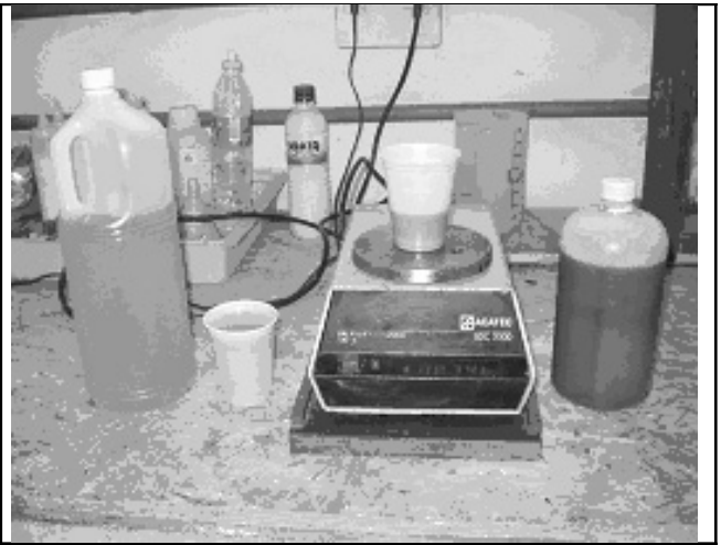
Figura 6 - Componentes de la resina poliuretana.
