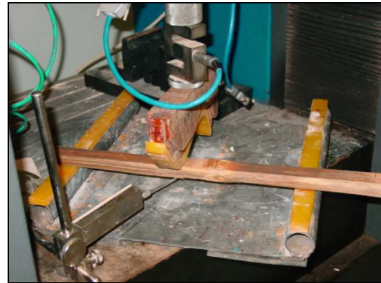
Figura 11- Ensaio de tração na flexão
